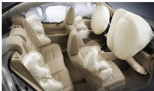
عندما يحدث الاصطدام، تقوم مجموعة من المجسّات الموجودة في وحدة التّحكم الإلكتروني بإغلاق الدّارة الكهربائية التي تحوي بداخلها مكثّفًا كهربائيًا، يوفر شحنة كهربائية قادرة على بدء التّفاعل الكيميائي بين المواد الموجودة داخل أسطوانة صغيرة
