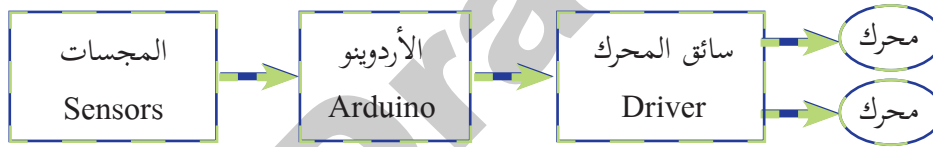
شكل (1-4): المخطط الصندوقي لروبوت متتبع الخط
