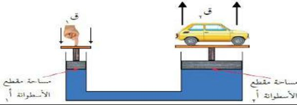
يتكوّن المكبس الهيدروليكي الذي تستخدم فيه السوائل (وعادة الزيت) من اسطوانتين إحداهما صغيرة ومساحة مقطعها (أ) و الأخرى كبيرة ومساحة مقطعها (ب) ، وعندما تؤثر قوة (ق<sub>1</sub>) على الاسطوانة الصغرى ينتج عنها ضغطاً (ض<sub>1</sub>) فإن هذا الضغط سينتقل إلى أجزاء السائل جميعها بالتساوي، فينشأ ضغط (ض<sub>2</sub>) على مكبس الاسطوانة الكبرى، وبما أن (ض<sub>1</sub>) = (ض<sub>2</sub>) حسب مبدأ باسكال، فإن :
