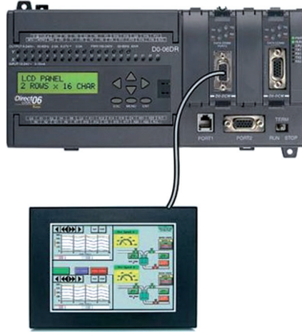
شكل (٦) : وحدة المشغل (HMI) موصولة مع جهاز PLC
