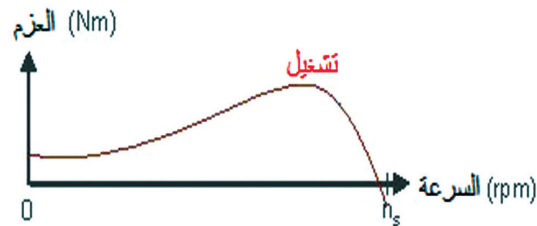
الشكل (٦-٤) : الخواص الميكانيكية لمحرك ذو المكثف الدائم
