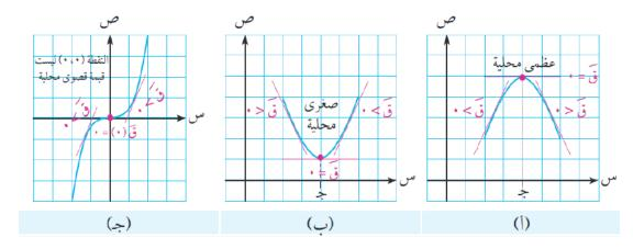
في الشكل (أ):  $\sigma(+)$  قيمة عظمى محلية للاقتران  $\sigma(m)$ ،  $\sigma'(+) = -m$  وغي الشكل (أ):  $\sigma(m)$  تغيرت من موجبة لقيم m > + m
