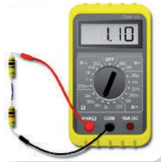
الشكل (٤) قياس المقاومة بجهاز المالتيميتر
