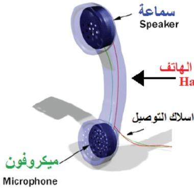
يُعدّ المايكروفون محول طاقة (Transducer) حيث يعمل على تحويل الصوت إلى إشارة كهربائية يمكن معالجتها ونقلها عبر أسلاك الهاتف إلى المشترك على الطرف الآخر. وعادة ما يتواجد المايكروفون داخل يد سماعة الهاتف (Handset)، كما هو مبين في شكل (2)
