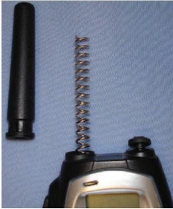
شكل (5): هوائي حلزوني يستخدم كأحادي قطب قصير
