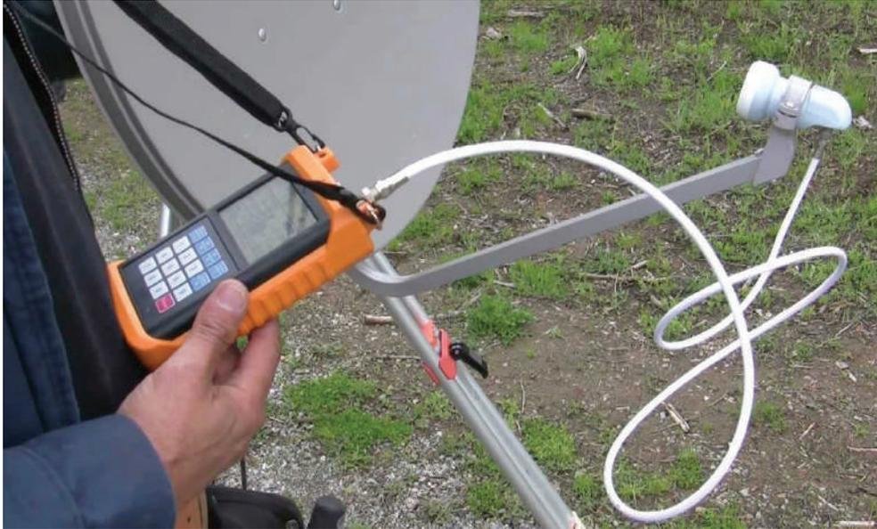
شكل (12): معايرة الهوائي الصحن واللاقط باستخدام جهاز ضبط الإشارة
