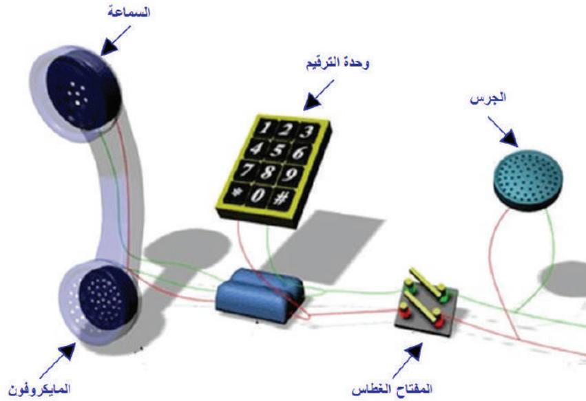
شكل (2) مكونات جهاز الهاتف
