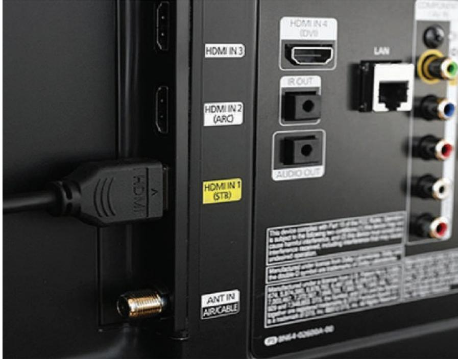
شكل (5): جهاز تلفاز ذكي (Smart TV) يحتوي 4 مداخل HDMI
