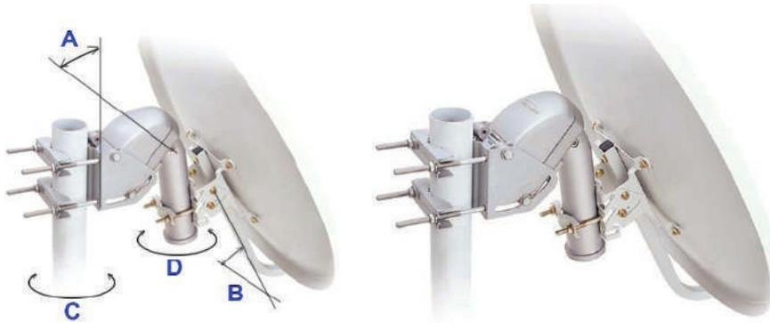
شكل (9): توجيه الصحن وضبط زاوية ميلانه باتجاه القمر الصناعي
