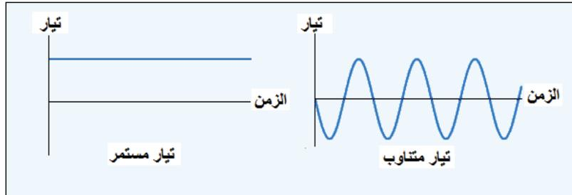
شكل (3): شكل إشارتي التيار المستمرّ والتيار المتناوب
