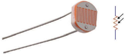
شكل (2): شكل مقاومة (LDR) ورمزها
