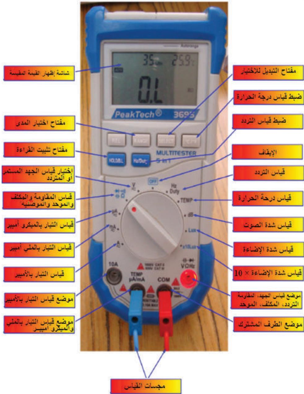
شكل (1): واجهة جهاز قياس متعدد الأغراض
