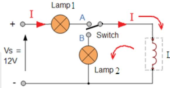
شكل (4) تحول المجال المغناطيسي للملف إلى تيار كهربائي
