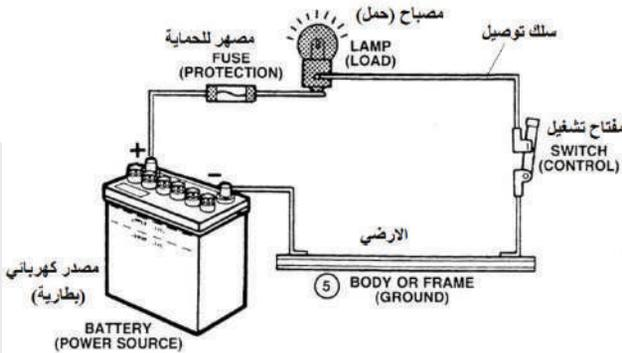
شكل (2): مكونات دارة كهربائيّة بسيطة
