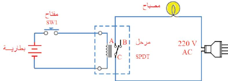
شكل (4): دارة بسيطة للتحكم بتشغيل حمل كهربائي باستخدام مرّحل
