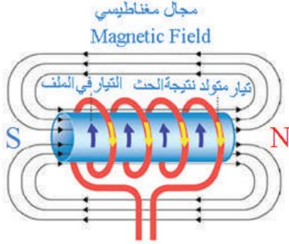
يتكون الملف الكهربائي من عدد من اللفات من سلك موصل معزول يتم لفها حول قلب من مادة ما، وهو عنصر كهربائي يمتلك خاصية تخزين الطاقة الكهربائية على شكل مجال مغناطيسي حوله (شكل 3).
