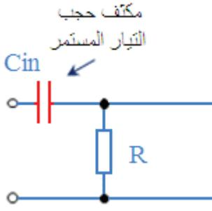
شكل (5): مكثف ربط (لحجب التيار المستمر)
