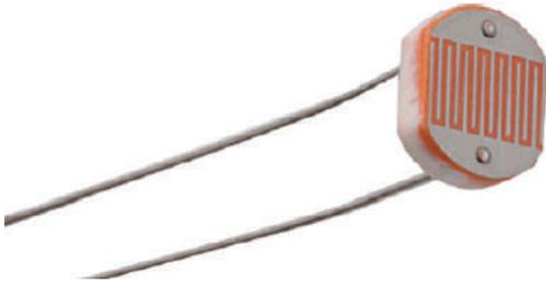
وهي مقاومات تتغير ذاتياً حسب الضوء المسلط على سطحها، وتستخدم عادة كحساس ضوئي، فهي تزيد قيمتها في الظلام، وتنقص أمام الضوء. تُستخدم هذه المُقاومات أساساً في بناء حسّاسات للضوء. يوضّح شكل (9) شكل المقاومة ورمزها.
