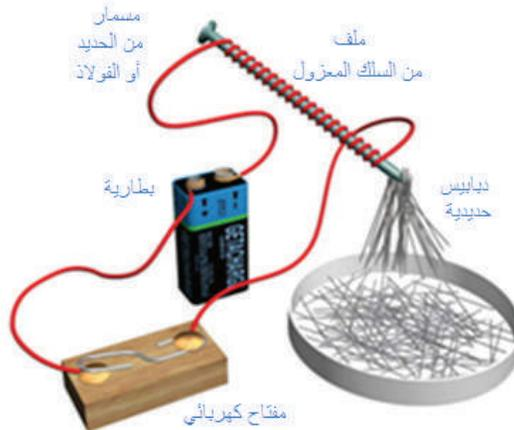
شكل (2): عمل مغناطيس كهربائي بسيط
