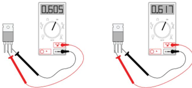
**نشاط** عند استخدام ساعة القياس الرقمية (DMM) (على وضعيّة فحص الثنائيّ)، لفحص أحد الترانزستورات ومعرفة نوعه (PNP أو NPN) وتحديد أطرافه (E, B, C)، ظهرت القراءات المبينة في شكل (9).
