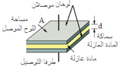
يتكوّن المكثف الكهربائي في أبسط أشكاله من لوحين موصلين تفصل بينهما مادة عازلة، ويتّصل بهما طرفا التوصيل للمكثف (شكل 2).
