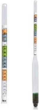
نبذة علمية: يعتبر مقياس السوائل (الهيدروميتر) أداة تستخدم لقياس الكثافة النسبية للسوائل، أي نسبة كثافة السائل إلى كثافة الماء.
