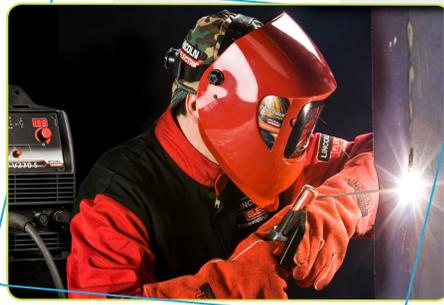
تمكّن الإنسان من ربط قطعتين من الحديد معاً بالحداثة، وذلك باستخدام الحرارة والضغط، وقد ظهرت فكرة استخدام الحرارة الناتجة عن القوس الكهربائي في عمليات لحام المعادن في أواخر القرن الماضي، ويعد اختراع أسلاك اللحام نقطة تحول في اللحام بالقوس الكهربائي، لقدترته على حماية خطوط اللحام من المؤثرات الخارجية التي تؤدي إلى تشقق اللحام.
