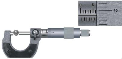
ب- المايكروميتر: أداة قياسٍ تمتازُ بسهولة استخدامها، ودقّتها التي تصل إلى ٠,٠١ ملم، وتوجدُ على عدّة أنواعٍ وأحجامٍ طبقاً لاستخدامها، ويمكن استخدامها لقياس السّمكات الدّقيقة.
