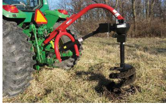
حفار يعمل بقوة الجرار
