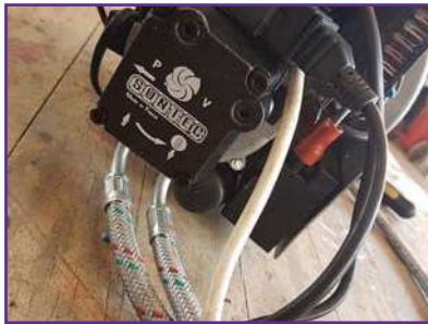
2. إحضار حارقة الوقود السائل وتحديد مضخة الوقود.
