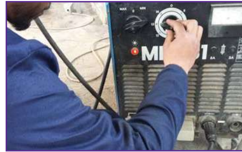
4. ضبط التيار الكهربائي المناسب ومعايرته حسب سمك المعدن المراد لحامه.
