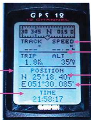
الشكل رقم (١) مكونات نظام تحديد المواقع العالمي
