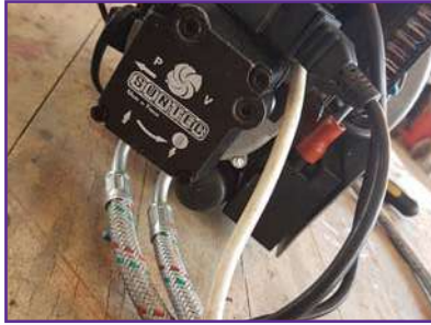
2. إحضار حارقة الوقود السائل وتحديد مضخة الوقود.
