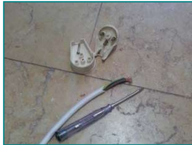
8. توصيل طرف (كابل) التغذية الآخر مع فيشة ذكر لتوصيلها مع مصدر الكهرباء
