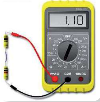
الشكل (٤) قياس المقاومة بجهاز المالتيميتر
