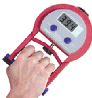
شكل (٣) جهاز ديناموميتر لقياس قوة القبضة
