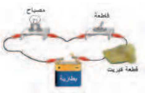
الشكل (4): توصيل قطعة كبريت بالدارة الكهربائية
