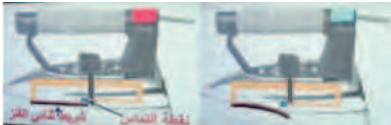
الثرموستات في دائرة المكواة الكهربائية
