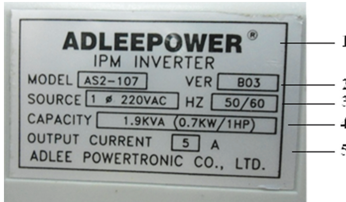
شكل (٤-٢٥): لوحة بيانات العاكس من شركة ADLEEPOWER
