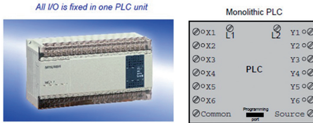
شكل (٤) : جهاز PLC متكامل
