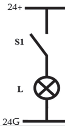
شكل (٣٧) : مخطط الدائرة الكهربائية تعمل بجهد مستمر (24V)
