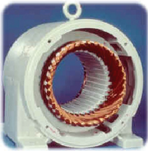
الشكل (٤-٢٠): العضو الساكن لمحرك حثي ثلاثي الطور
