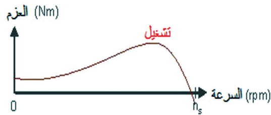
الشكل (٦-٤) : الخواص الميكانيكية لمحرك ذو المكثف الدائم
