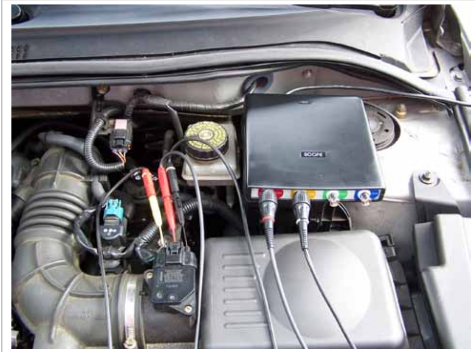
شكل رقم (٢): شكل وطريقة توصيل لاقطات الإشارة
