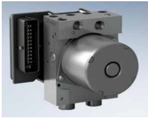
شكل (١٩): المجمع الهيدروليكي لنظام ESP
