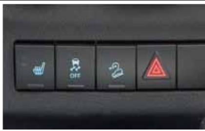
شكل (١٧) : مفتاح إبطال تفعيل نظام TCS
