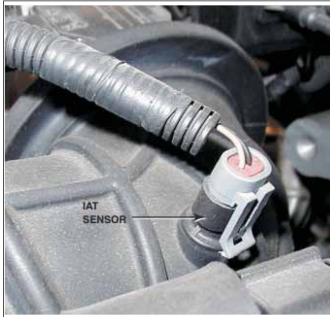
الشكل (٥٠) موقع تركيب مجس درجة حرارة الهواء الداخل للمحرك
