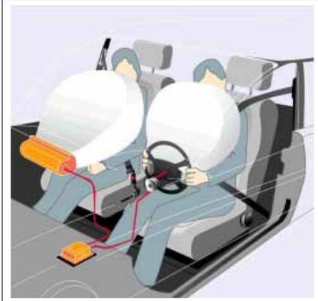
شكل (٢٨): الحماية التي يوفرها نظام وسائد الهواء ومشدات أحزمة الأمان
