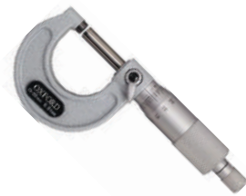
الميكروميتر الخارجي العادي: يستخدم لقياس الأبعاد الخارجية، مثل الأقطار الخارجية والسطوح.
