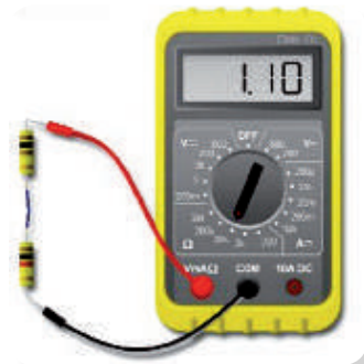
الشكل (٤) قياس المقاومة بجهاز المالتيميتر
