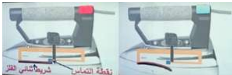
الترموستات في دائرة المكواة الكهربائية
