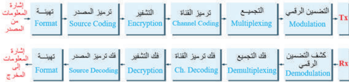
شكل (3) المخطط الصندوقي لنظام الاتصالات الرقمية
