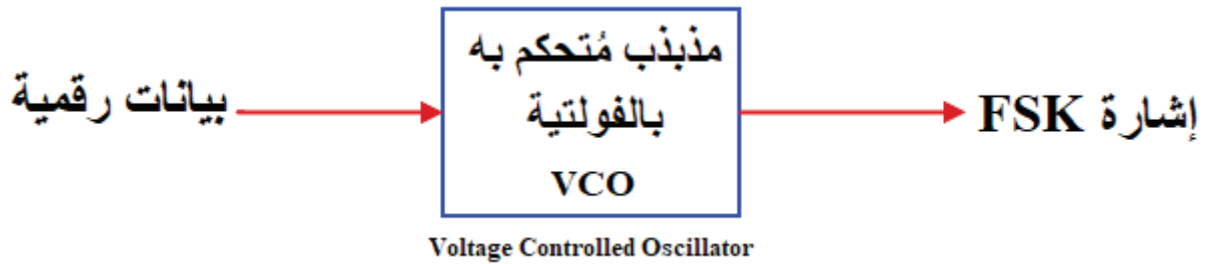
شكل (3) دائرة توليد إشارة "FSK"
