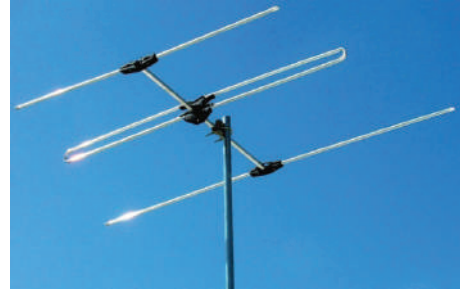
شكل (1): هوائي ياغي- أودا مختلفان في شكل الدايبل والأبعاد وعدد العناصر وتردد الموجة
