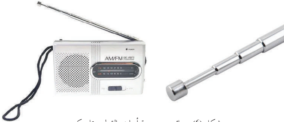
شكل (6): هوائي ربع موجة أحادي القطب تلسكوبي
