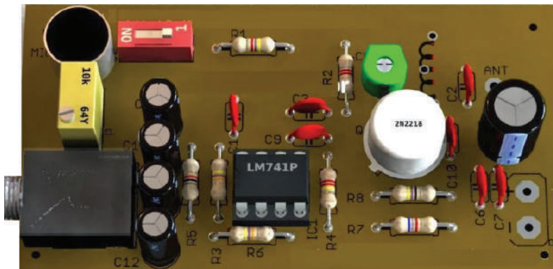
شكل (1): دائرة جهاز إرسال FM بسيط
