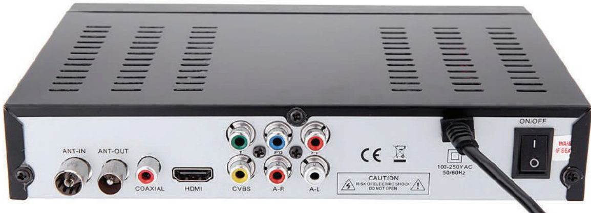
شكل (3): جهاز استقبال للقنوات الفضائية (رسيفر) يبين منافذه المختلفة
