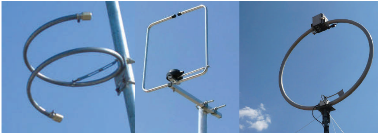
شكل (1): مجموعة من الهوائيات: أ- حلقي دائري ب- حلقي مربع ج- حلزوني
