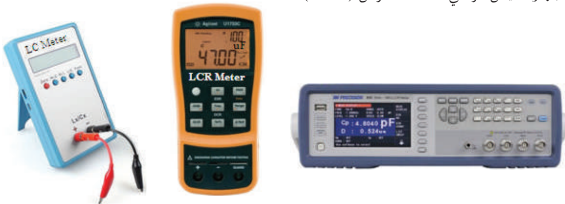
شكل (8): أجهزة قياس السعة والحثية
