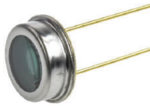
شكل (6): شكل الثنائي المستقبل للضوء ورمزه
