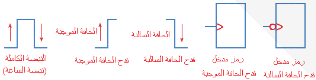
شكل (7): قديم النطاطات باستخدام نبضات الساعة
