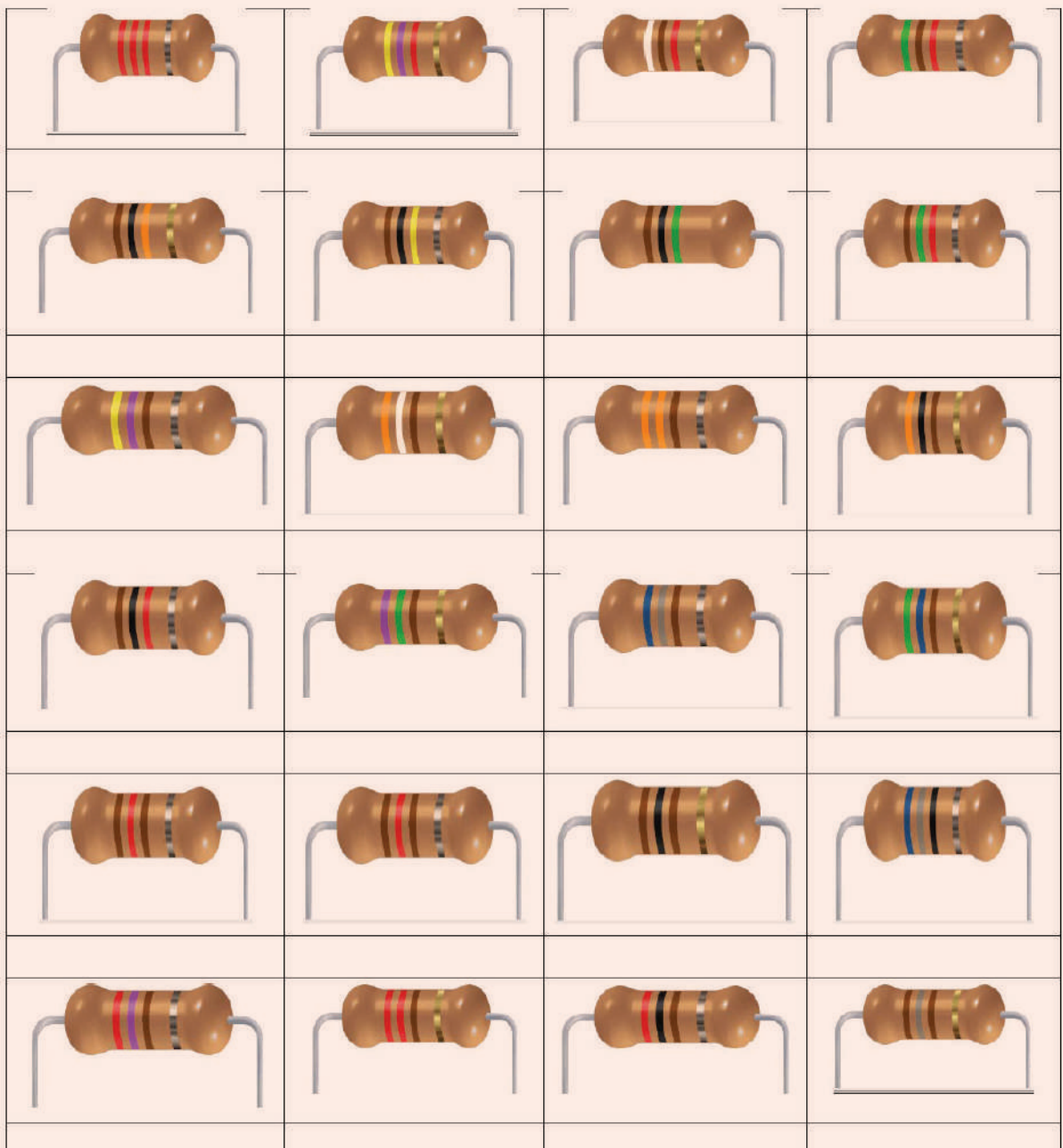
شكل (سؤال 5): أقوم بحساب قيم المقاومات باستخدام شيفرة الألوان
