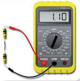
الشكل (٤) قياس المقاومة بجهاز المالتيميتر
